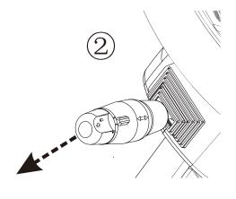
2. PULL DOWN THE CONTROL STALK TO ENABLE THE HIGH BEAM (AFTER LOW BEAM IS ENABLED)
