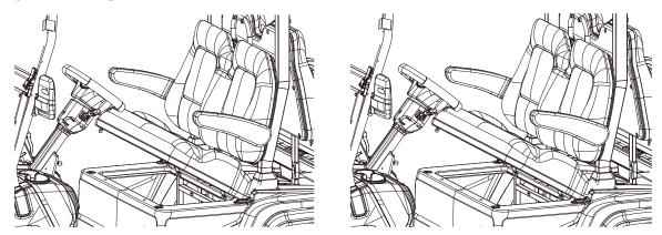
1.LIFT THE SEAT FROM THE FRONT SO THAT THE BALL AT THE BOTTOM OF THE SEAT SEPARATES FROM THE SOCKET ON THE BARREL.
