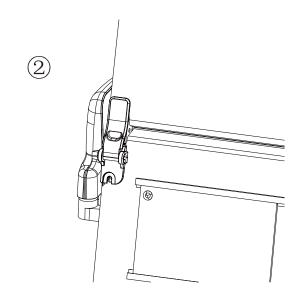
1.PUSH THE TIP OF THE REAR VIEW MIRROR INWARDS(PIC 1). 2.THE MIRROR CAN BE FOLDED INWARD 90 DEGREES(PIC 2).
