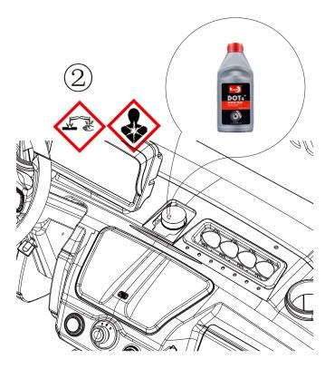
2.CHECK THE FLUID LEVEL ,ADD DOT 4 BRAKE FLUID TO THE TANK .
